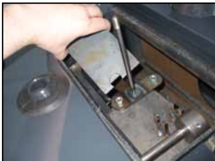
4. Lyft lyftspaken uppåt, ta bort konvektionskanalens lock.
