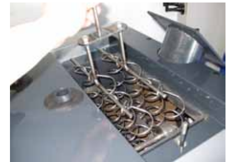
6. Lyft bort hållaren och spiralerna från konvektionen.
