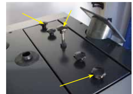
10. Sätt dit sotluckan och skruva in stjärnvreden.
