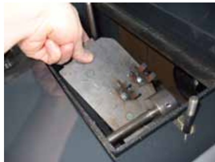
5. Lyft också av konvektionskanalens andra lock.
