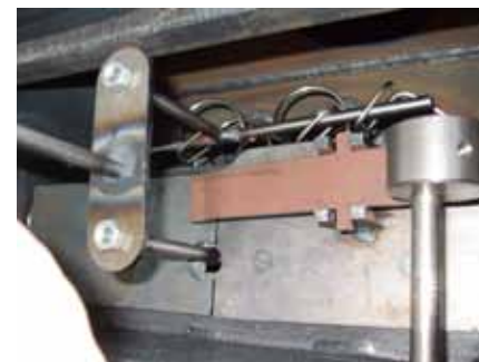
9. Sätt dit konvektionskanalens lock och vippbrytaren.
