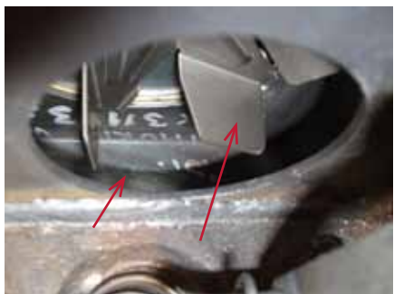
7. Rengör avgasfläktens blad och ta bort askan från fläktens box med t.ex. en asksugare.
