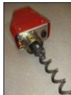
11. Spiralen monterad på motorn.
