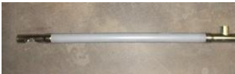
15. Skruvrör och T-rör sammankopplade.
